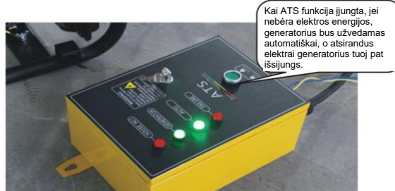
Įjungus ATS funkciją, jei nebėra elektros energijos, generatorius bus užvedamas automatiškai, o atsiradus elektrai generatorius tuoj pat išsijungs
